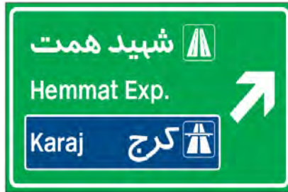
شکل ۲-۳: تابلوی پیش‌آگاهی معمولی نصب‌شده در بزرگراه برای آدرس‌دهی به بزرگراه و آزادراه
