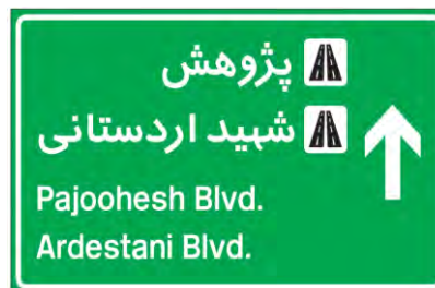
شکل ۲-۵: نمونه تابلو پیش‌آگاهی معمولی - آدرس‌دهی به دو معبر شریانی
