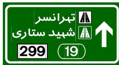
شکل ۲-۴: نمونه تابلو پیش‌آگاهی معمولی - آدرس‌دهی به دو بزرگراه
