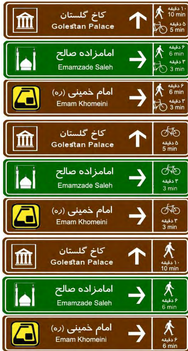
شکل ی ۵-۳۷: طرح شماتیک تابلوهای استک تایپ
