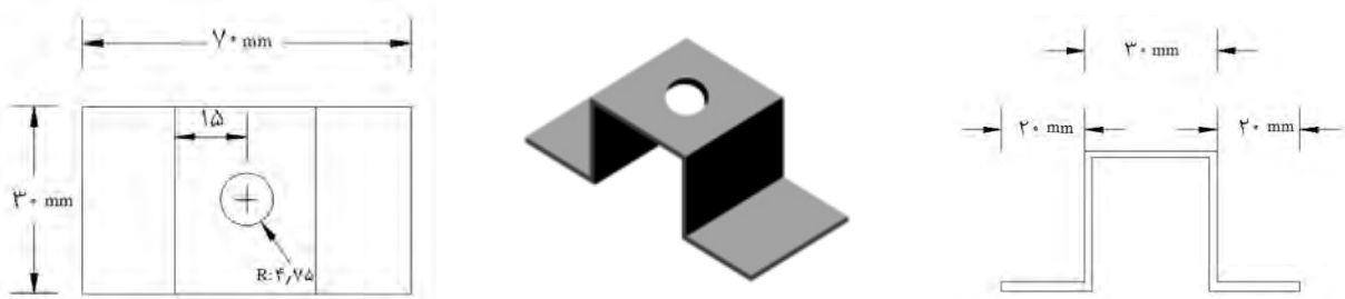
شکل ب-۵-۲۰: نمایی از بست زیرسری به پشت صفحه تابلو
