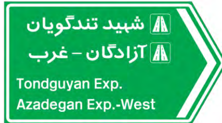
شکل ۱۰-۳: نمونه‌ای از تابلوهای خروجی پرچمی نصب‌شده در بزرگراه با آدرس‌دهی به بزرگراه
