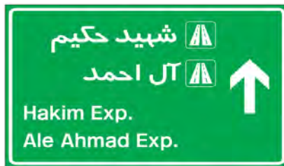
شکل ۲-۴: نمونه تابلو پیش‌آگاهی معمولی - آدرس‌دهی به دو بزرگراه
