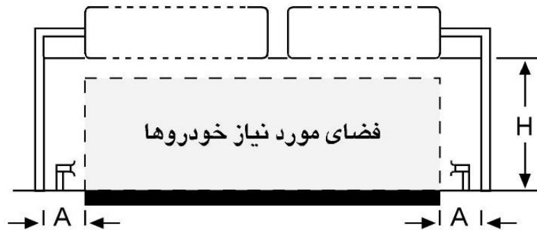
شکل ب ۵-۱۳: تابلوی بالاسری برای پهنای سواره‌رو
