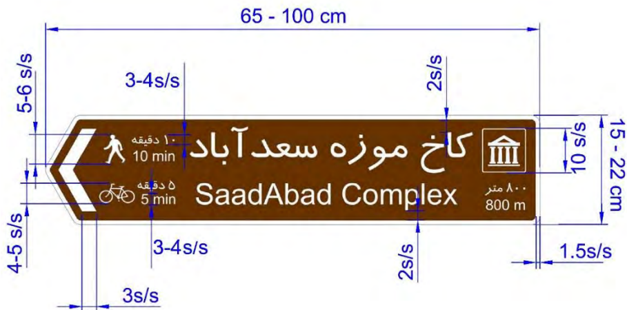
شکل ی ۳۴-۵: جزئیات طراحی تابلو طرح قدم به صورت پرچمی
