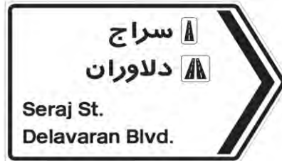
شکل ۱۱-۲: نمونه تابلوی خروجی پرچمی اشاره‌کننده به معبر شریانی
