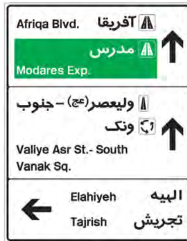
شکل ۳-۱۳: نمونه‌ای از تابلوهای پشت‌های نصب‌شده در معبر شریانی اصلی و فرعی و جمع و پخش‌کننده
