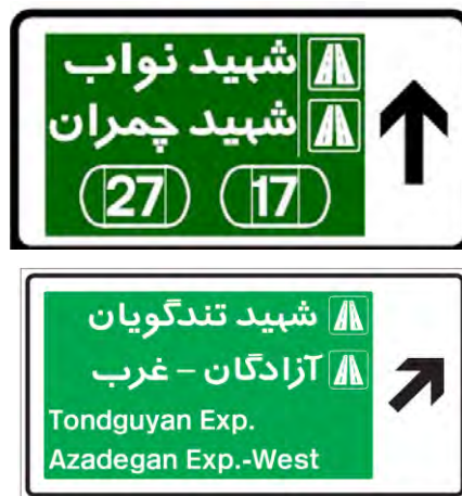
شکل ۲-۲: تابلوی پیش‌آگاهی معمولی نصب‌شده به صورت بالاسری
