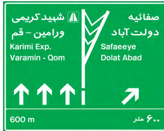
شکل ۲-۹: نمونه تابلوی پیش آگاهی مشخص کننده خطوط
